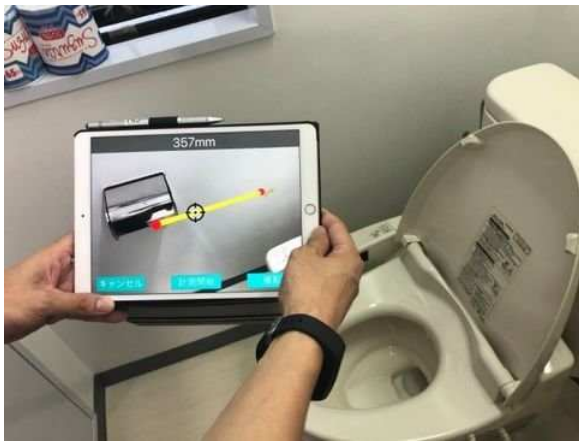
自社開発の見積AIアプリで手すりの設置
